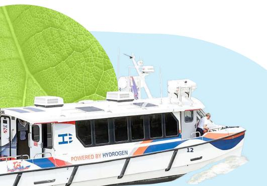
Hydroville ist das erste zertifizierte Fahrgastschiff, dessen Dieselmotor mit Wasserstoff betrieben wird (Antwerpen, Belgien).
